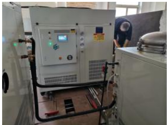
电镀废水低温蒸发浓缩设备
