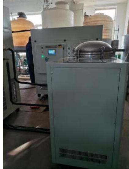
电镀废水低温蒸发浓缩设备
