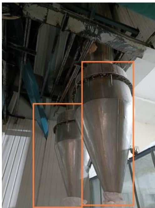
干燥装置两级旋风除尘装置
