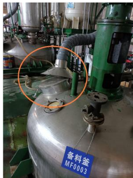
备料釜（中和反应）废气收集装置
