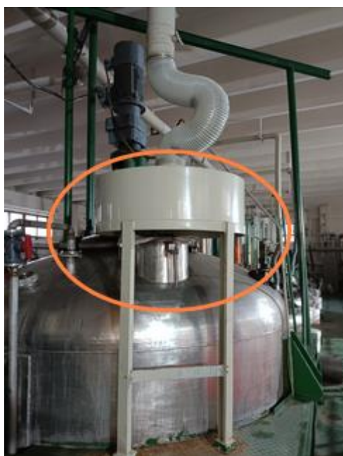
主反应（聚合反应）废气捕集装置
