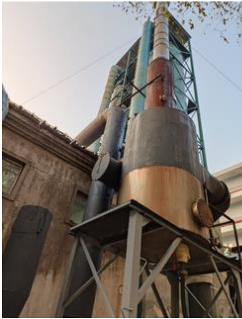
干燥工序除尘装置
