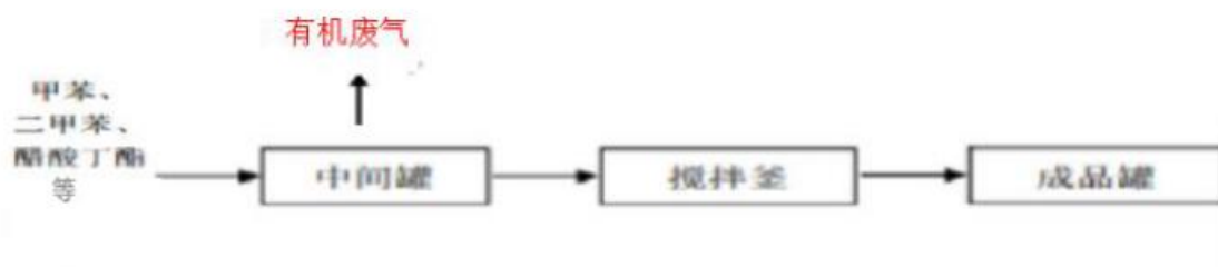
图 3-5 稀释剂生产工艺流程
