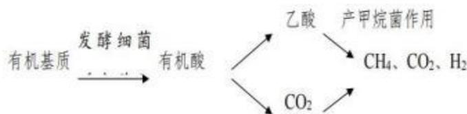
图 2-2 厌氧处理工艺流程图
