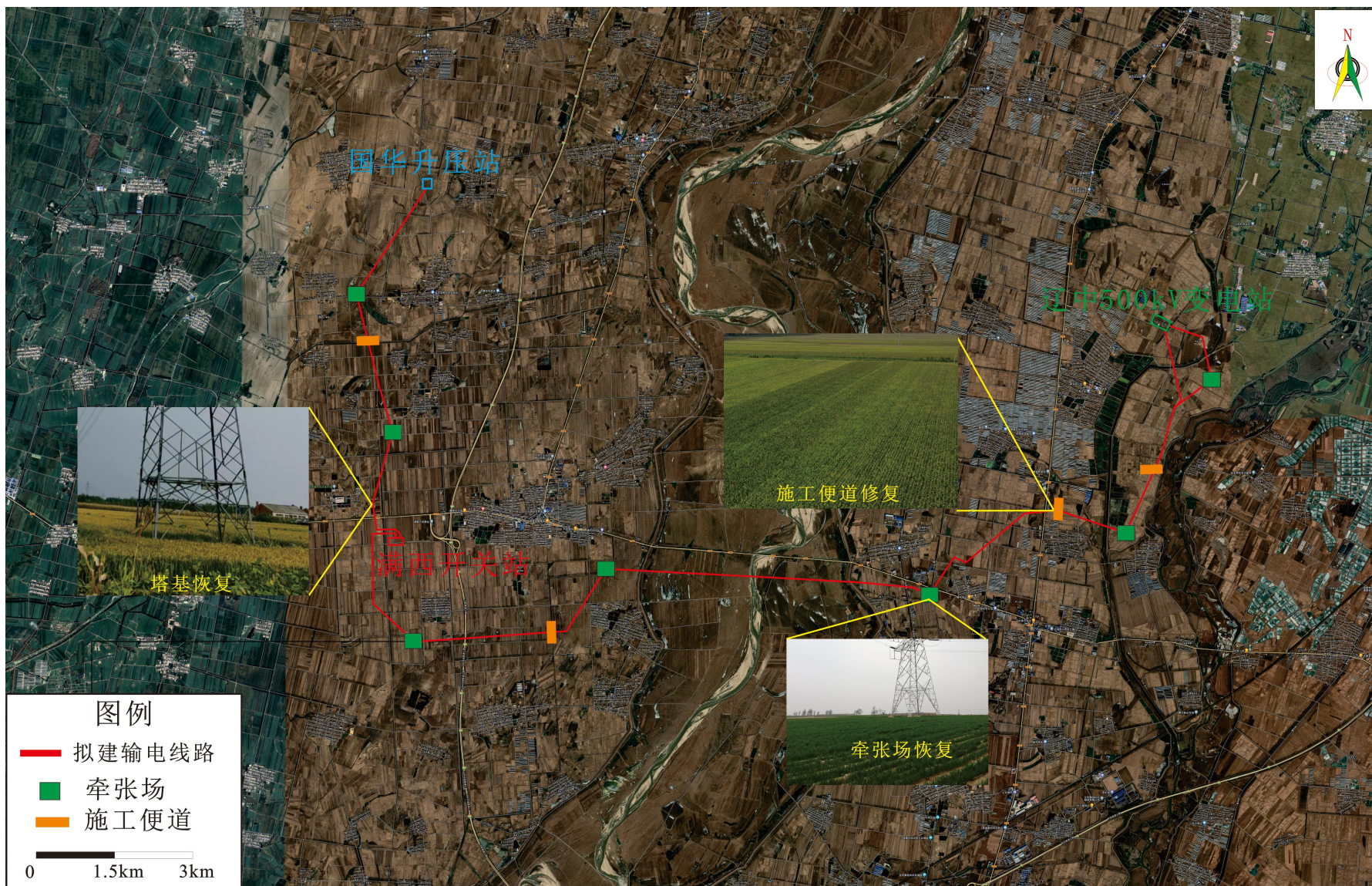
附图8 本项目施工总平面布置及典型措施设计示意图
