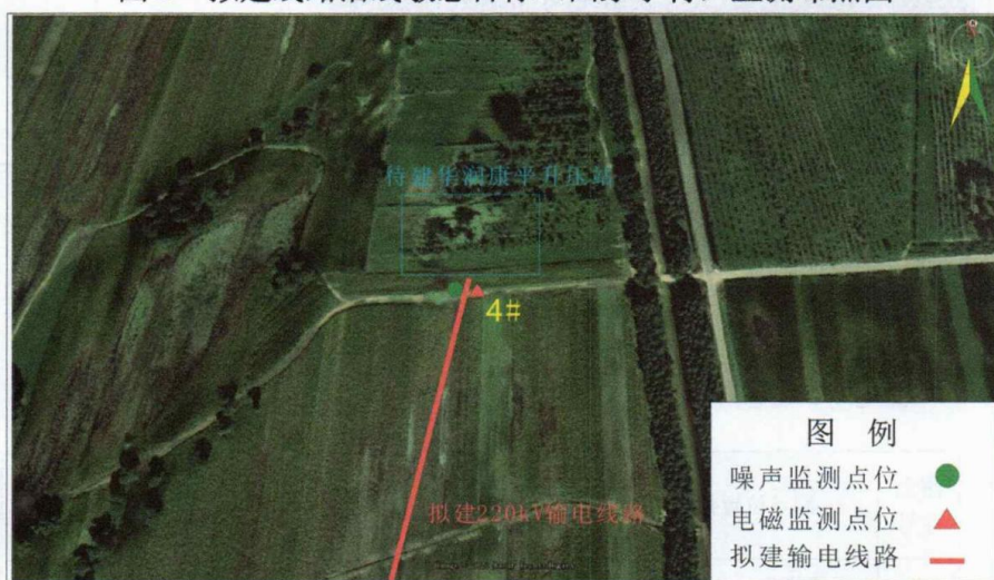
图4 待建升压站出线处监测布点图
